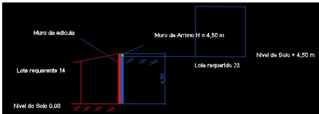
Imagem 07 – Localização de divisa entre Parede de divisa e o Muro de Arrimo
